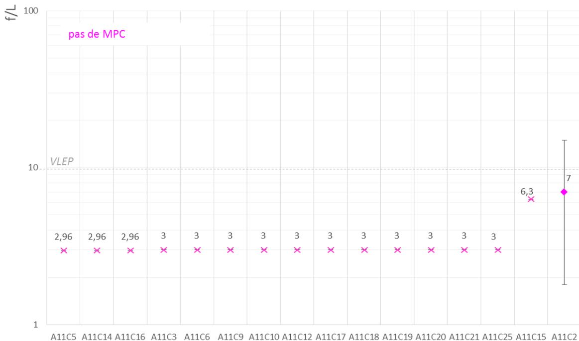
A noter que les deux valeurs pour lesquelles des fibres d'amiante ont été dénombrées (A11C15 et A11C2) correspondent à des situations d'intervention sur matériaux dégradés.
